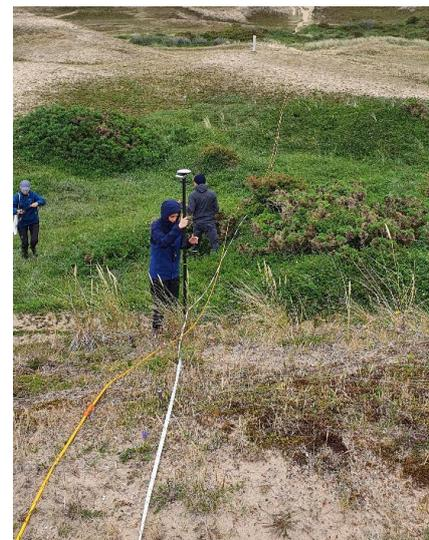
Figure 4 : Relevé des profils au DGPS – 2021 (source : LGP)
